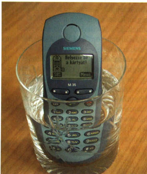
A Siemens M35 a fürdőt követően felmondta a szolgálatot, rövid száradás után azonban ismét működőképes állapotba került.
